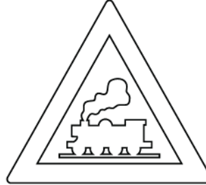
KONTROLSÜZ DEMİR YOLU GEÇİDİ
